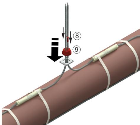
**Шаг 5:** Наденьте на нагревательные секции опору УВК.01.01 (Поз. 5) и протяните кабель вверх. Вставьте уплотнение в опору.
