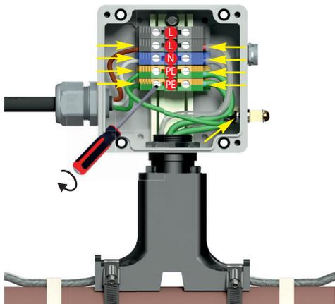
**Шаг 15:** Для завершения монтажа закройте крышку корпуса коробки и зафиксируйте ее четырьмя невыпадающими винтами.
