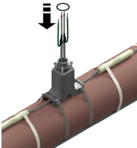
**Шаг 9:** Излишек кабеля протяните обратно через опору (A) в сторону обогреваемого объекта. Закрепите излишек кабеля с помощью адгезивной крепежной ленты FT/HTM (B). Затяните крепежные винты на опоре (C) с усилием, достаточным для выполнения герметизации нагревательной секции в опоре.
