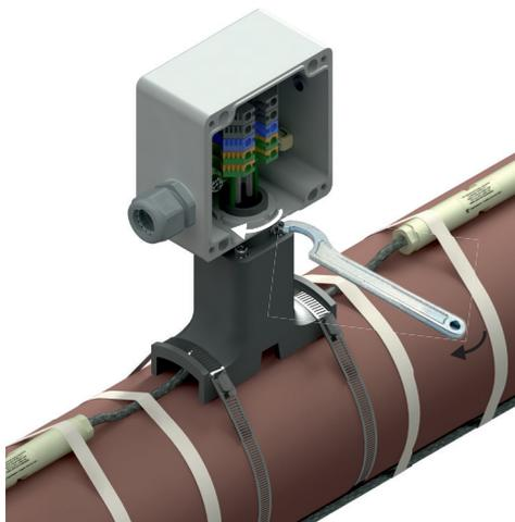
**Шаг 13:** Через кабельный ввод введите силовой кабель на достаточную длину для выполнения подключения к клеммным соединителям.
