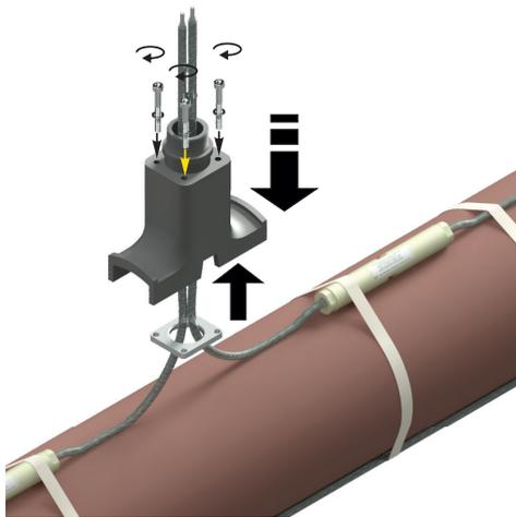
**Шаг 7:** Установите опору на трубопровод и закрепите ее с помощью хомутов PFS / 3 (Поз. 14) таким образом, чтобы хомуты не пережимали нагревательную секцию.
