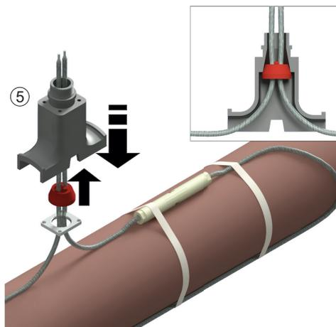
**Шаг 6:** Вставьте в опору сверху четыре винта крепежа уплотнения (размер под ключ 4 мм) с шайбами и наживите их в пластину с помощью ключа-шестигранника (в комплект поставки не входит). Не затягивайте винты до конца. Это нужно будет сделать на заключительном этапе монтажа.
