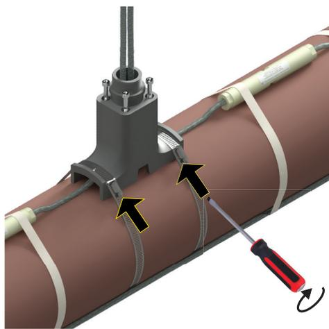
**Шаг 8:** После того, как на нагревательные секции будут установлены комплекты заделок, сверху на опору наденьте кольцо прямоугольного сечения (Поз. 6).
