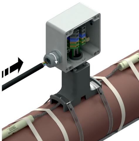
**Шаг 14:** Подключите силовой кабель и провод заземления к клеммным соединителям. Выполните подключение нагревательных секций и соедините с клеммами заземления оплетки нагревательного кабеля. Соедините лепесток болта заземления и клемму заземления перемычкой.
