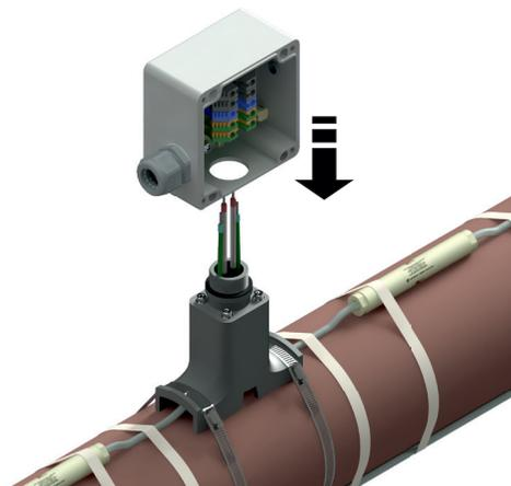
**Шаг 12:** Зафиксируйте корпус коробки на опоре с помощью гайки ДЭСТУ.0002. Гайка закручивается с помощью ключа для круглых шлицевых гаек под внешний диаметр гайки от 45 мм до 52 мм (ключ в комплект поставки не входит).
