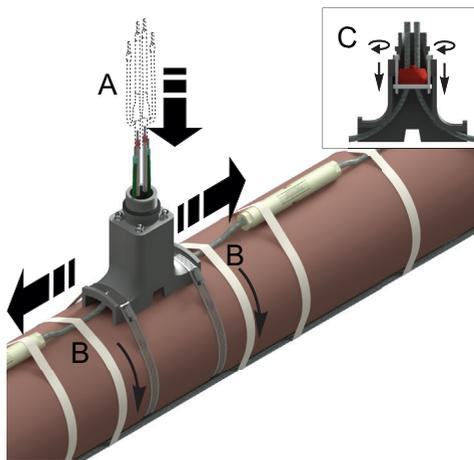
**Шаг 10:** Установите кабельные вводы и заглушки из комплекта поставки соединительной коробки в отверстия в соответствии с моделью коробки и ее назначением. Внутри кабельных вводов установите уплотнения и затяните гайки кабельных вводов.
